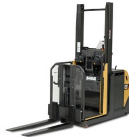
Doté de la plus faible hauteur de marchepied du marché, ce préparateur vous fait gagner du temps et réduit les efforts. L'accès rapide et simple, sans obstacle, est assorti d'un capteur de présence qui recouvre la totalité de la plate-forme, laquelle est protégée par un tapis matelassé antidérapant.
