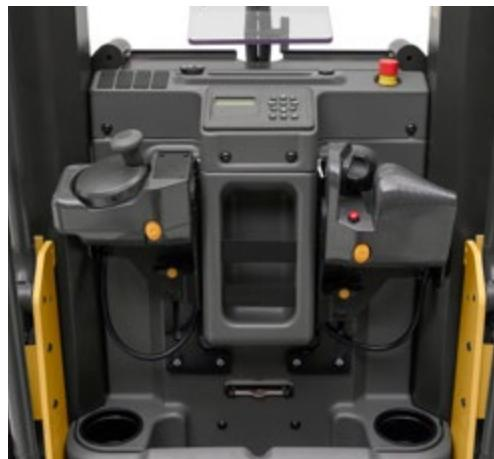
Sur l'interface utilisateur innovante, le cariste pilote l'unité de commande de la main droite. La position de l'unité est réglable assurant ainsi un confort anatomique idéal. Outre un contrôle précis des fonctions du chariot, cette interface assure un soutien ferme et confortable de la main droite, laissant la gauche actionner le volant Midi.
